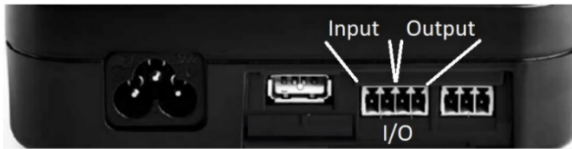
Afbeelding 21: INPUT / OUTPUT DCONNECT
