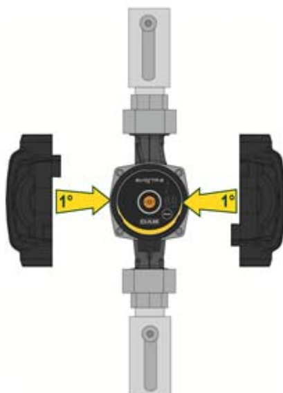
Rysunek 7: Izolacja korpusu pompy
