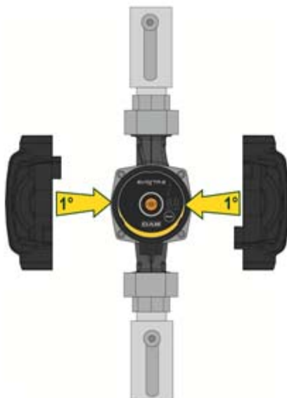
Obrázek 7: Izolace tělesa čerpadla
