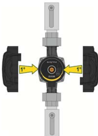
Рисунок 7: Изоляция корпуса насоса
