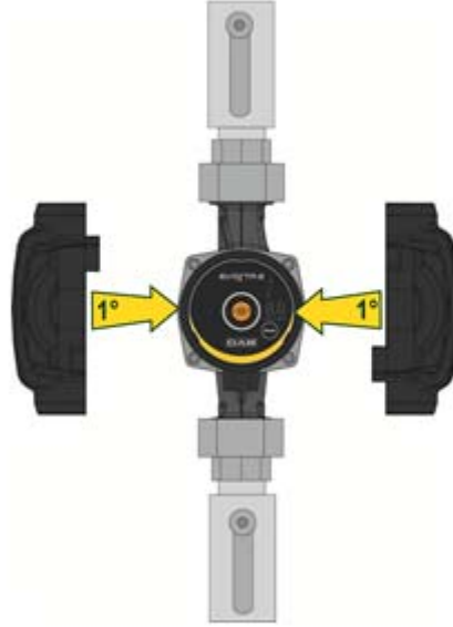
Resim 7: Pompa gövdesinin yalıtımı
