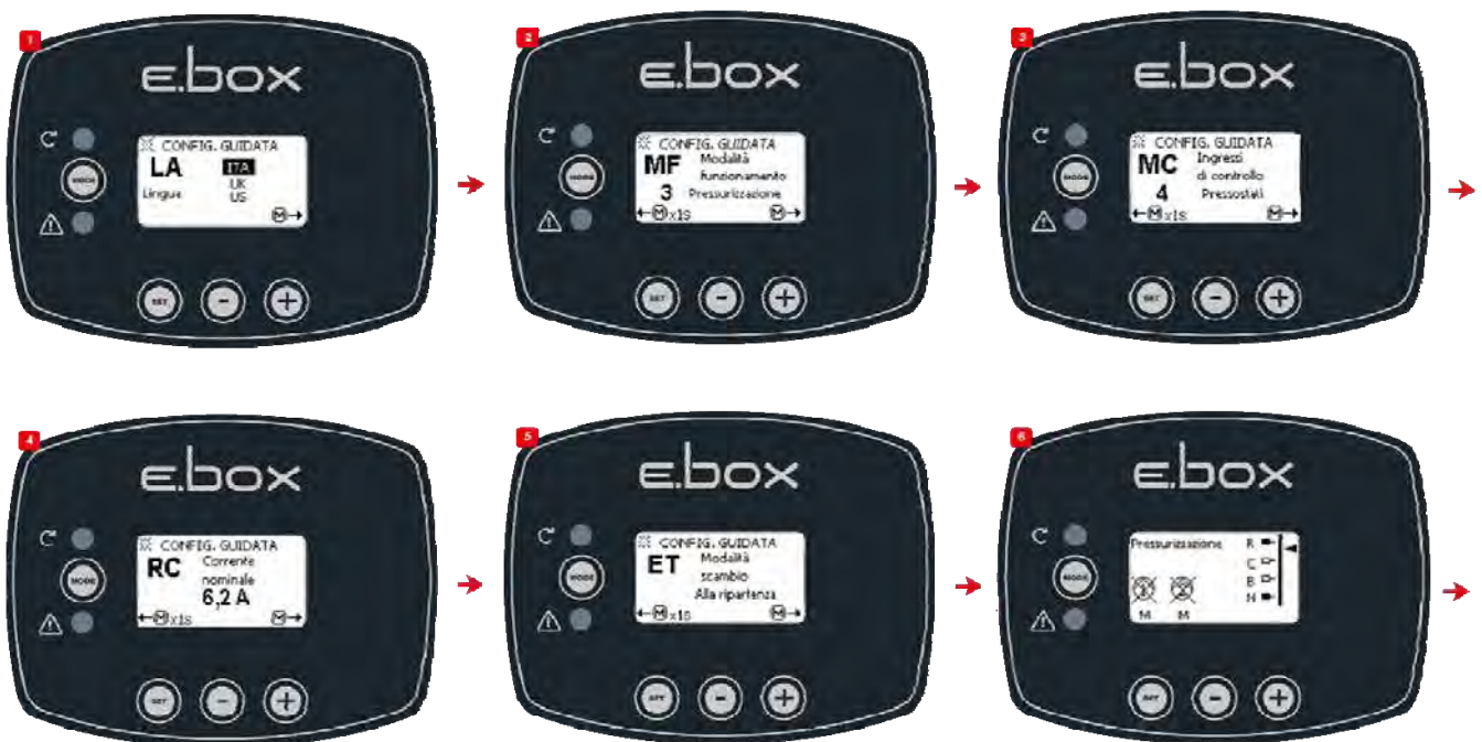
Abbildung 13: Konfiguration mit Druckwächtern
