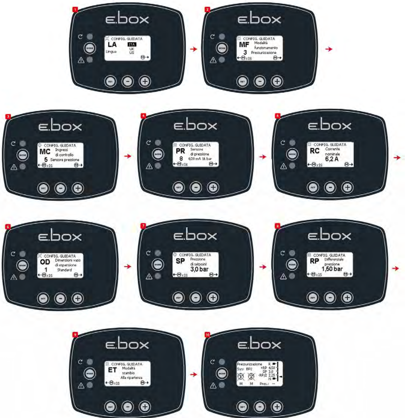
Figura 12: Configurare cu Senzor de presiune
