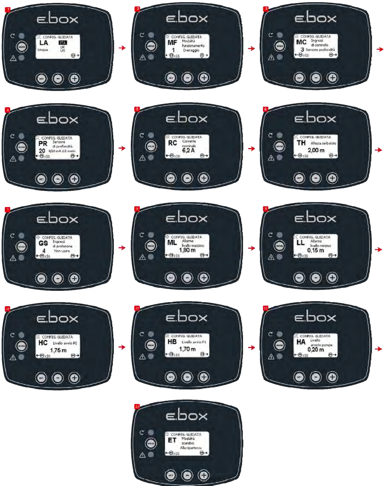
Figura 38: Configurare doar cu senzor de presiune
