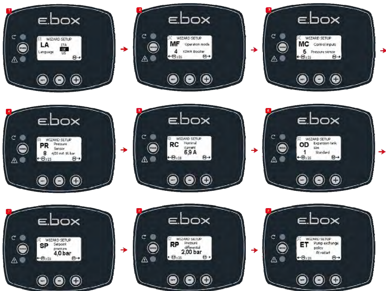
Figura 48: Presurización KIWA con sensor de presión
