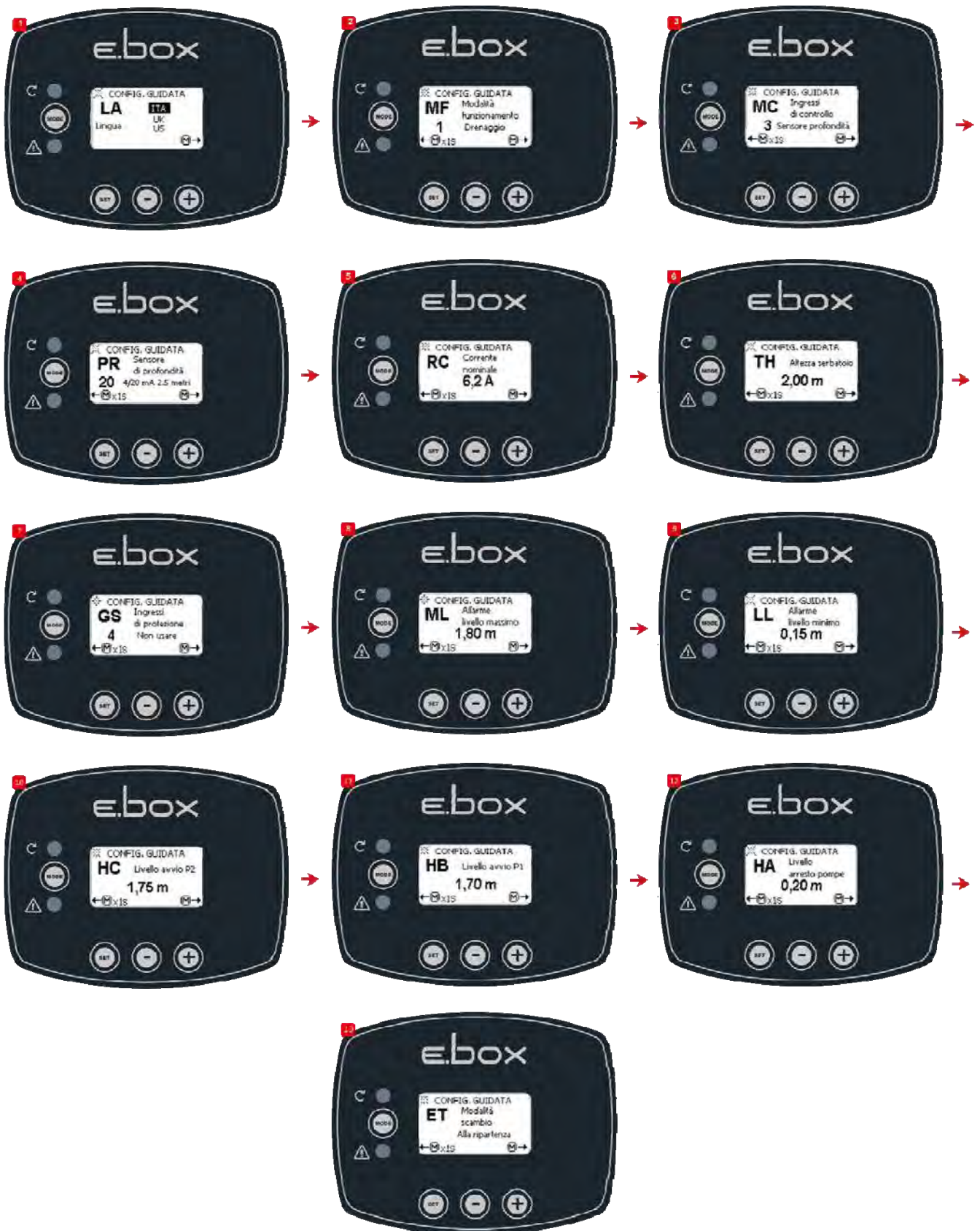
Abbildung 38: Konfiguration mit nur dem Tiefensensor
