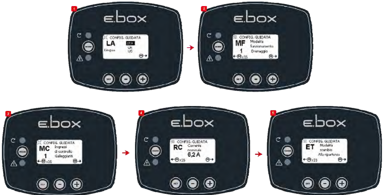
Abbildung 36: Drainage Konfiguration der Schwimmerschalter oder der Standsonden
