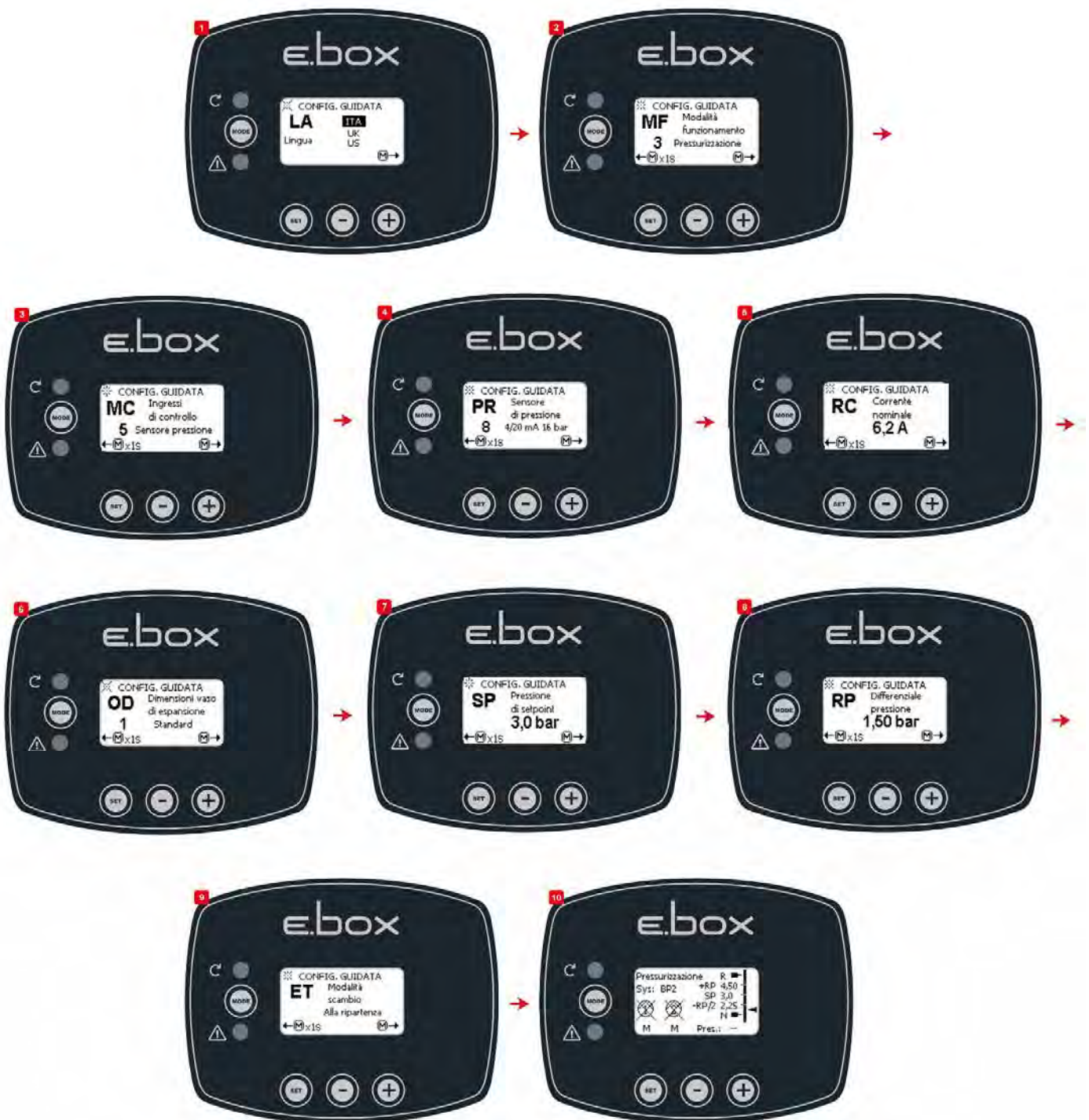
Afbeelding 12: Configuratie met druksensor
