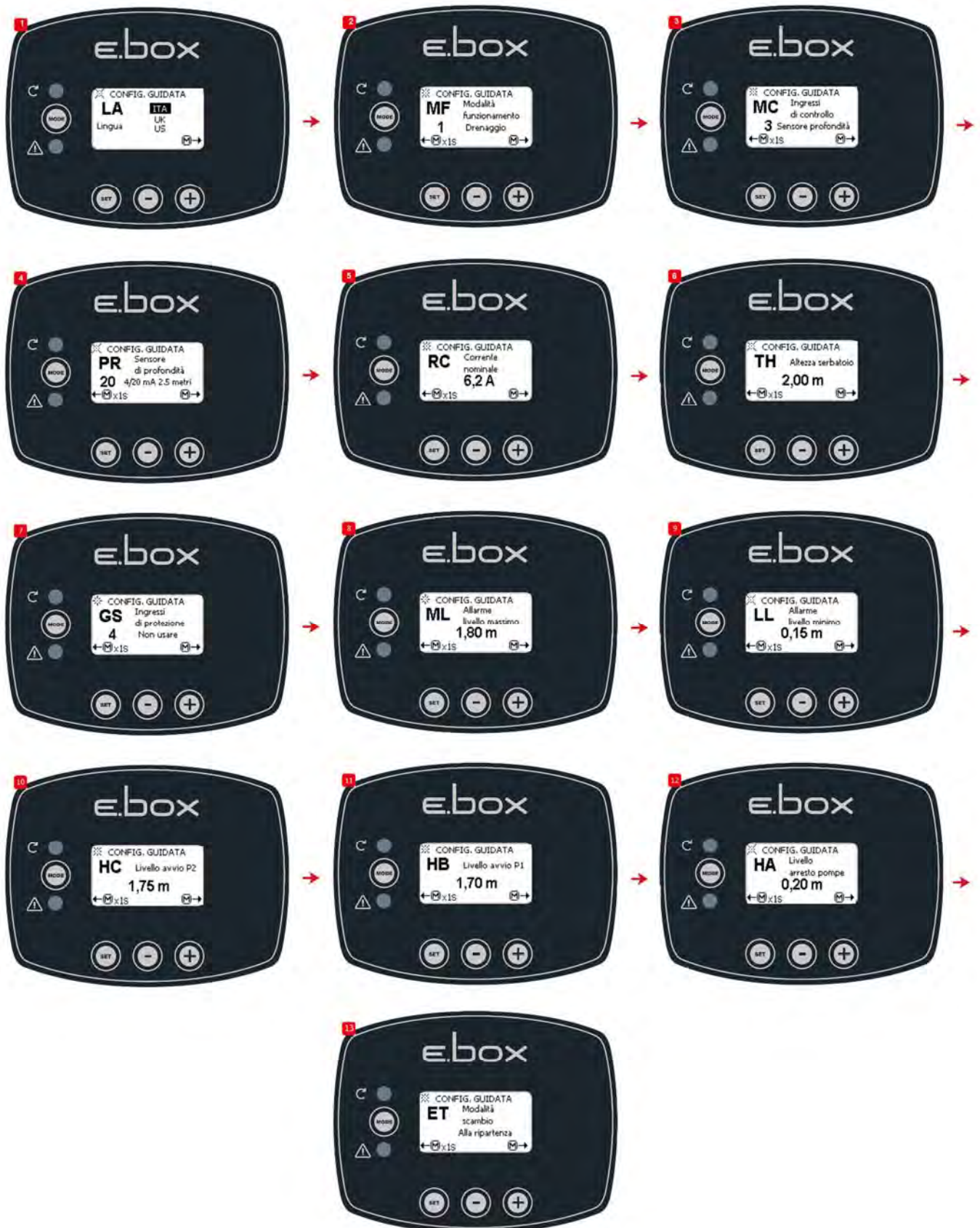
Figura 38: Configurazione con solo sensore di profondità
