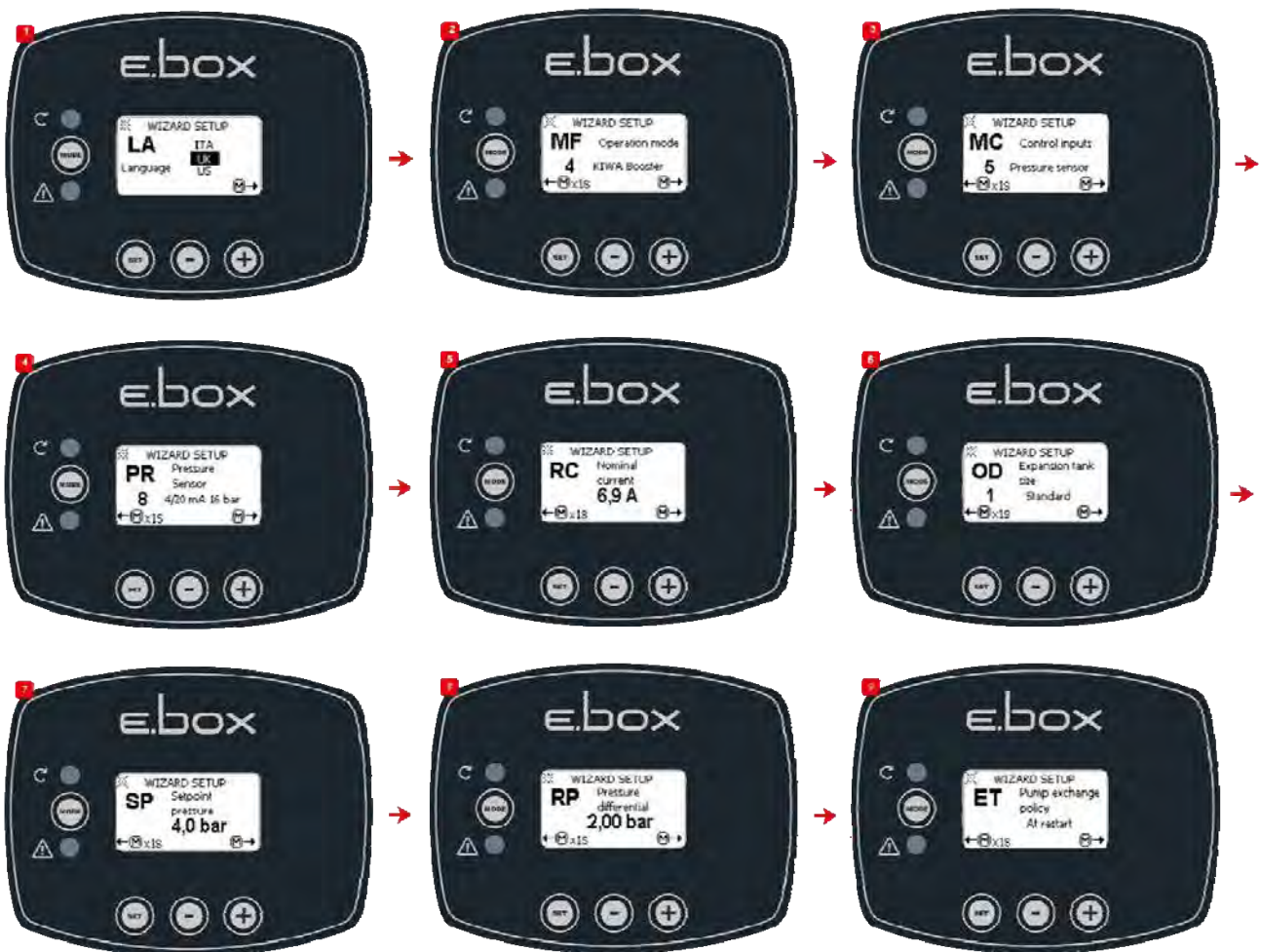
Afbeelding 48: Drukopbouw KIWA met druksensor
