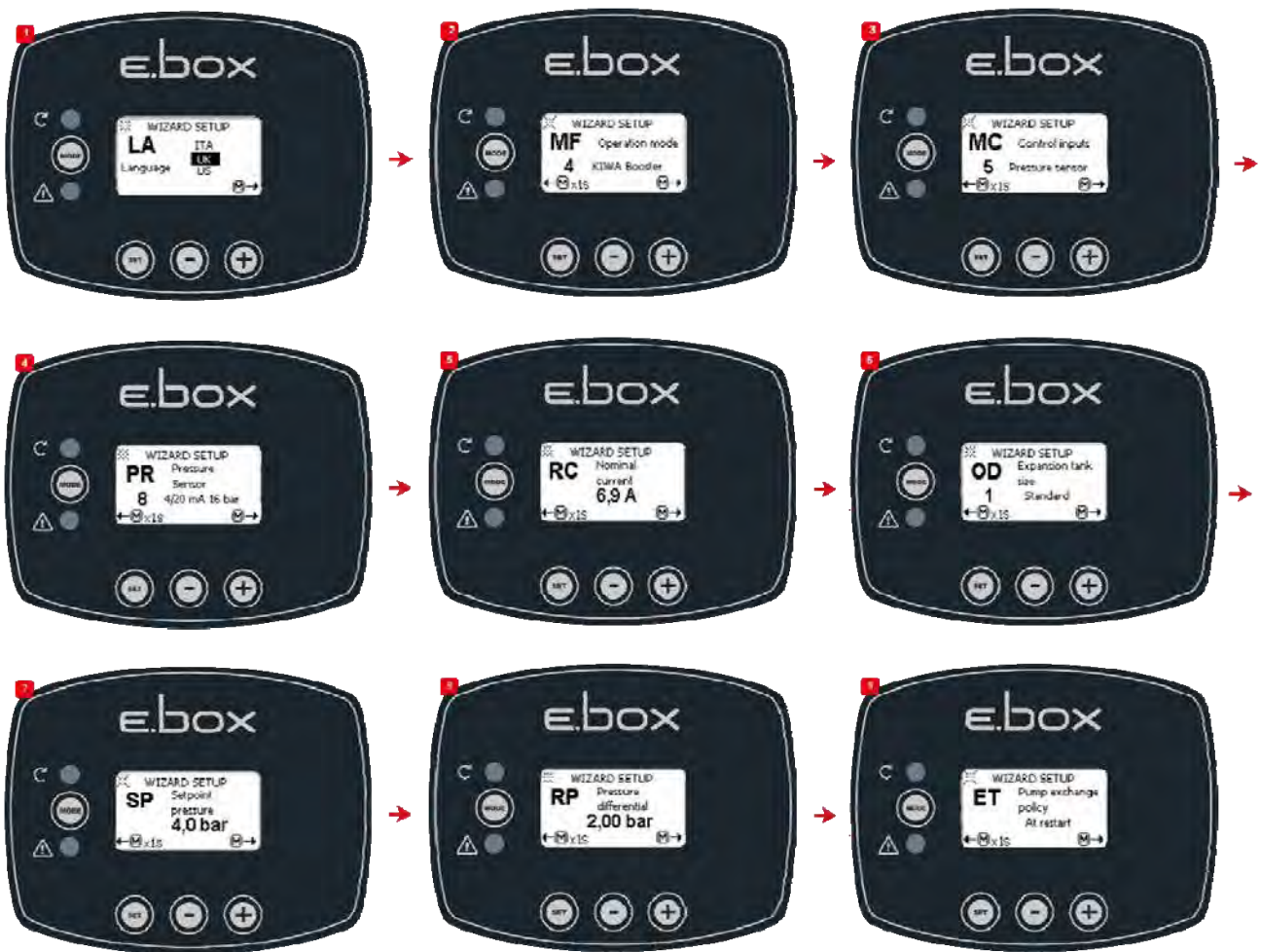
Figure 48 : Pressurisation KIWA avec capteur de pression
