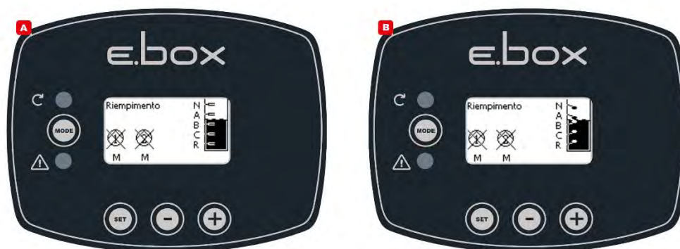
Схема 25: Состояние системы в режиме наполнения с контрольными вводами поплавков или зондов уровня.
