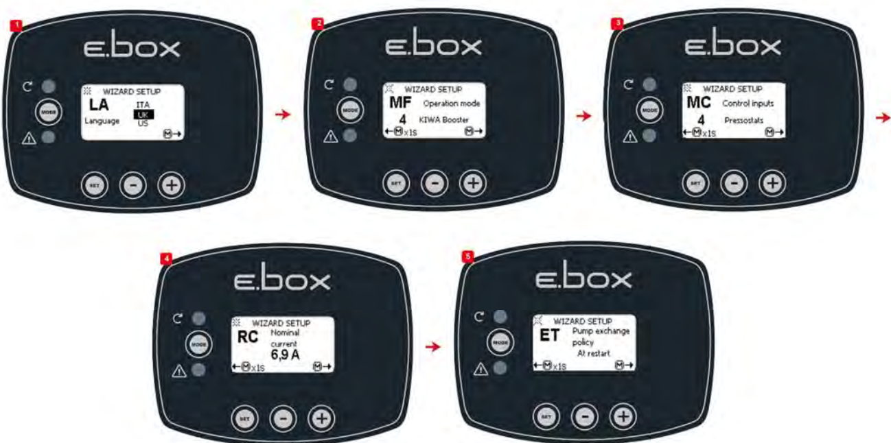
Figura 49: Configurazione Kiwa con Pressostati
