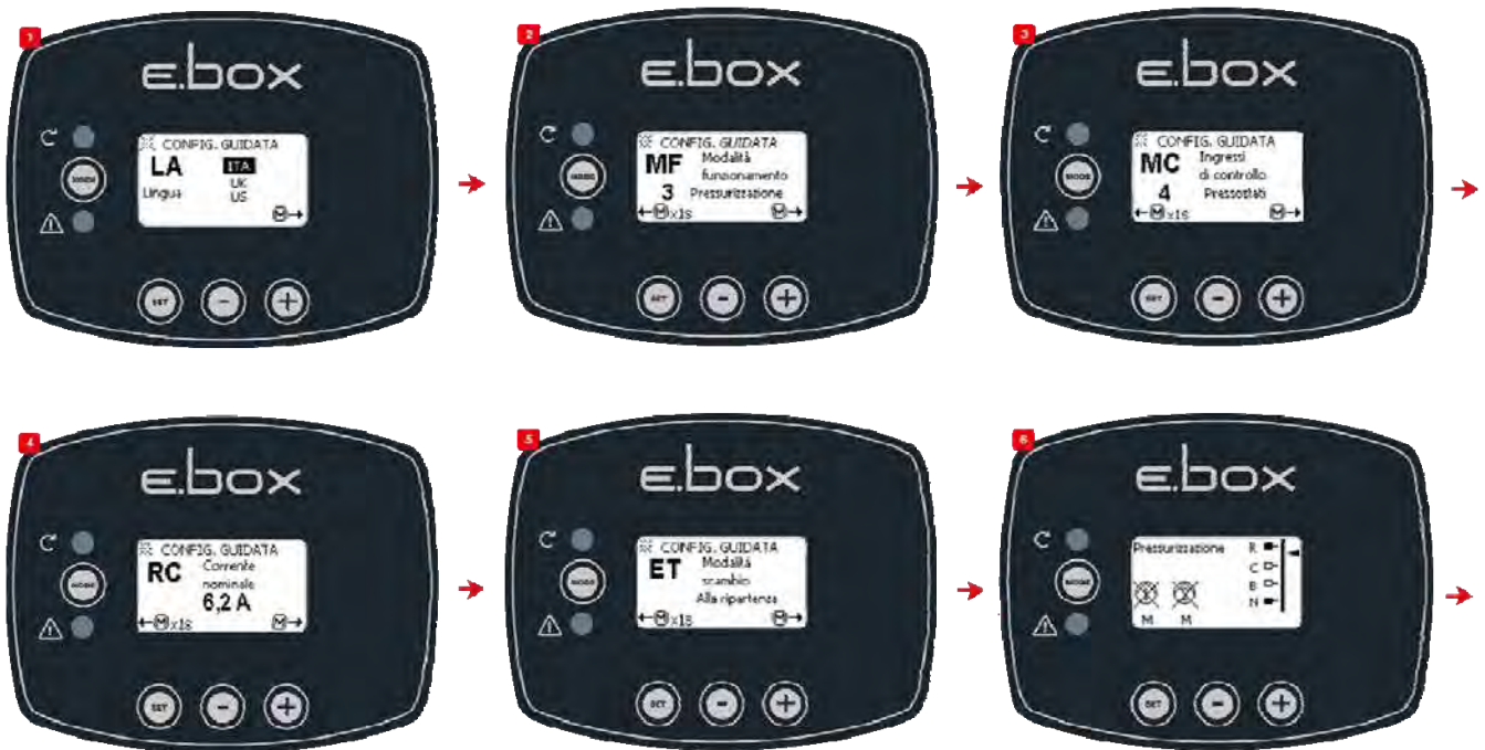
Afbeelding 13: Configuratie met drukschakelaars
