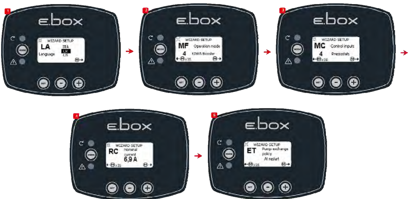
Abbildung 49: Konfiguration KIWA mit Druckwächtern
