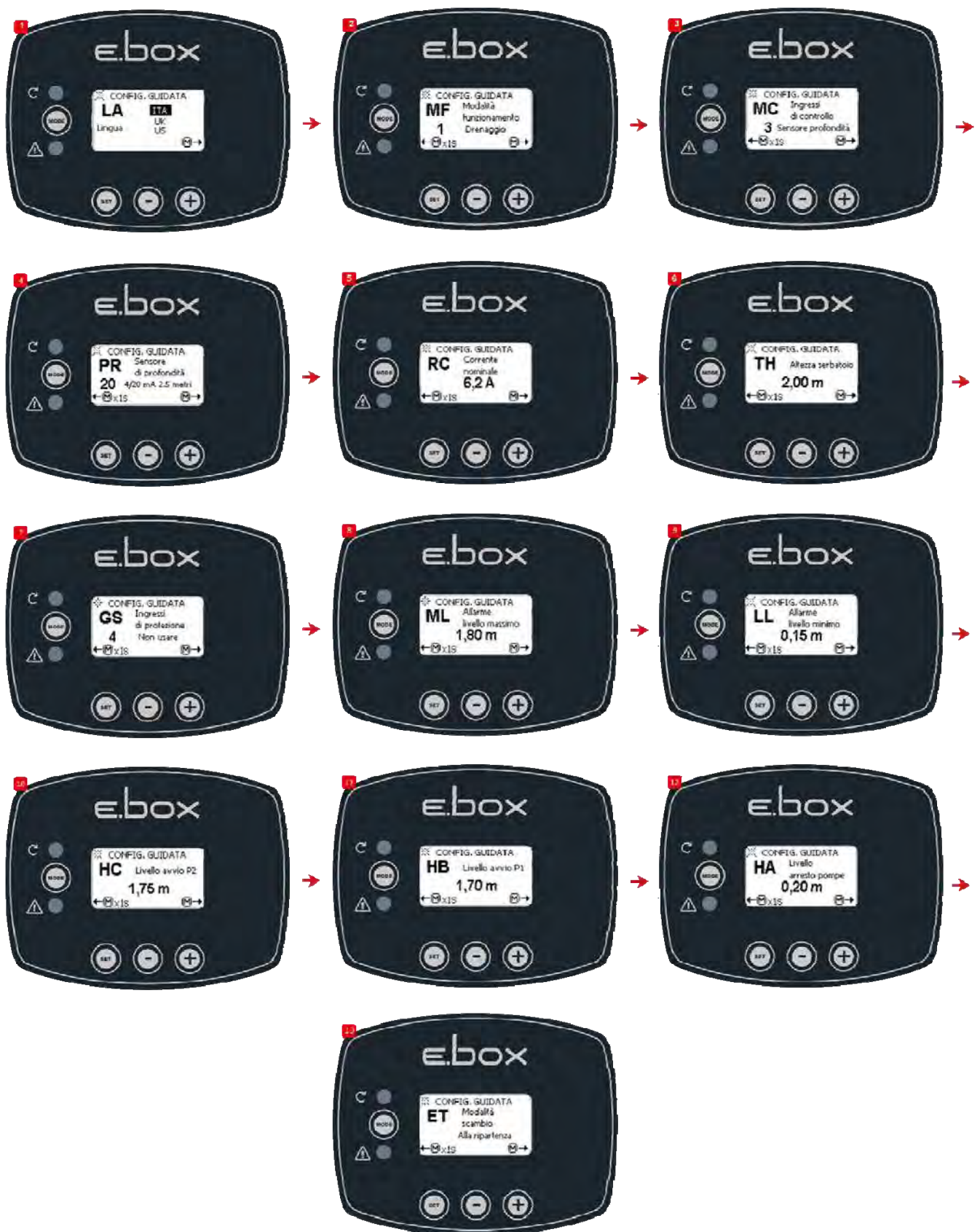
Схема 38: Конфигурация только с датчиком глубины
