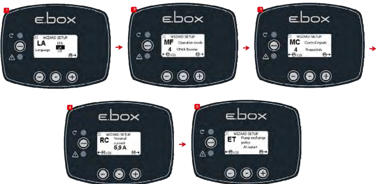
Figure 49 : Configuration KIWA avec des pressostats
