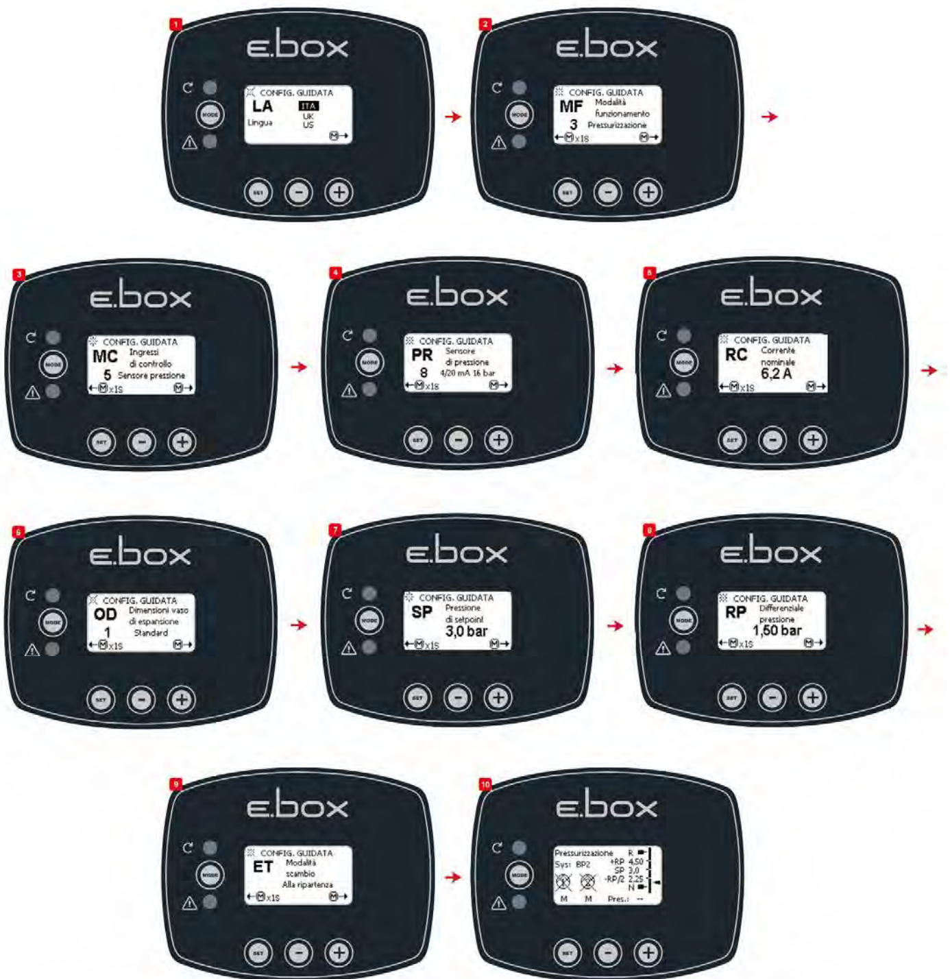
Схема 12: Конфигурация с датчиком давления
